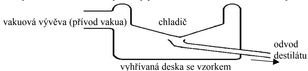
Obr. 6: Schéma zařízení pro molekulární destilaci.
