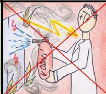
32 HAŠENÍ ELEKTR. ZAŘÍZENÍ
