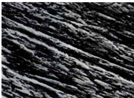
Obr. 1. 1500x zvětšený povrch ložiskové oceli, vyleštěné do zrcadlového lesku
