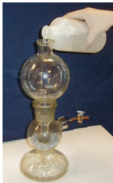
Obr. 2: Nalítí kyseliny střední částí přístroje. Odvod plynu ze střední části musí být uzavřen.
