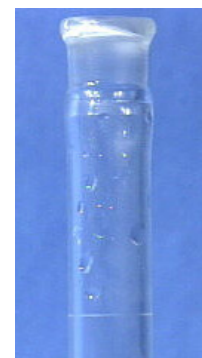
Obr. 1: Správný boční pohled na rysku odměrné baňky.
