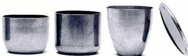
kovové kelímky (zleva doprava: kelímek nízký, se svislými stěnami, vysoký, víčko ke kelímku).
